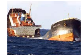
プレステージ号(西, 2002) 船齢26年 腐食 30,000トンの油流出
