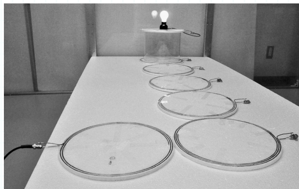
写真3 中継コイルによって伝送距離を伸ばす
